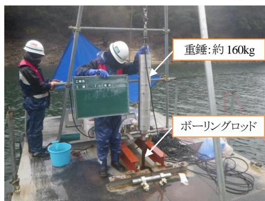
図-2 自重貫入型 RI コーンによる測定状況
