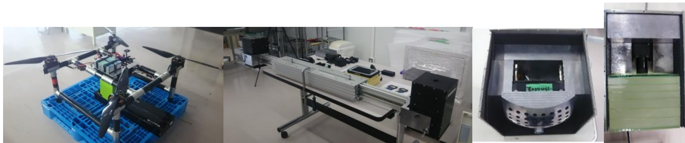
図1. 開発した有線給電ドローン 図2. 立体視ガンマカメラ 3. 耐放射線ガンマカメラとカラーカメラ
