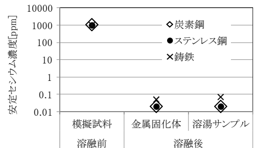
図 1 模擬試料を用いた基礎試験における金属中の安定セシウム濃度
