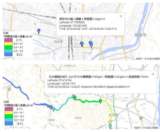
図2 GPSを用いた被ばく線量マップの例
