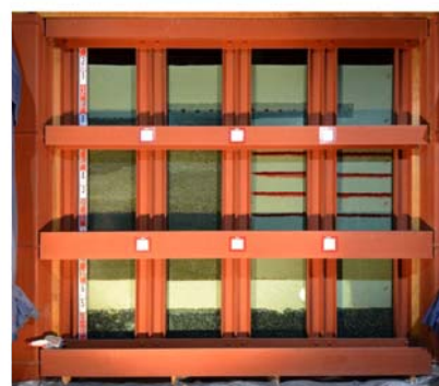
図-1 作製した大型実験土槽
