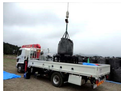
図-1 フレコン濃度測定車による測定状況 (日本遮蔽技研保有)
