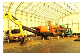
図4 実規模改質試験 土質改良機 SR-2000G(日立建機)
