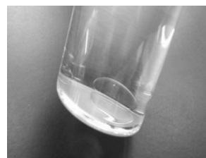
Fig. 1 試料水溶液中の Cs を濃縮した ENE 相 (容器底部の楕円上の液体)
