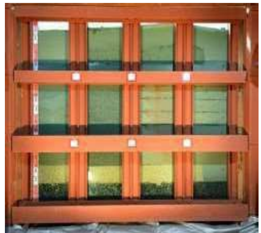
図 2 屋外実験 3 年後の土槽の状態
