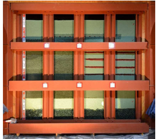
図 1 土槽の初期状態 (幅 2400 mm)
