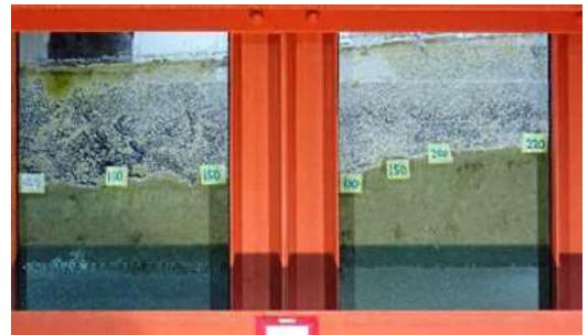
図 3 ベントナイト隔離層の膨潤変形
