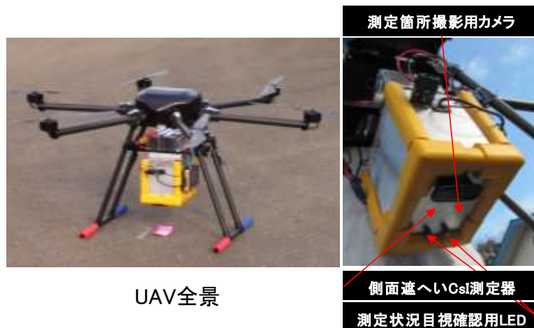
図1 使用したUAV（ドローン）および放射線測定器
