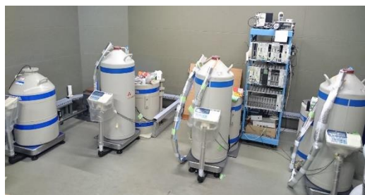
図 1: 東京大学宇宙線研究所の低バックグラウンド室に設置された Ge 半導体検出器
